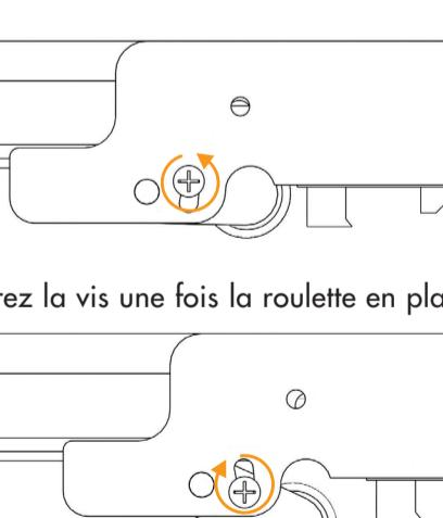
Resserrez la vis une fois la roulette en place.
