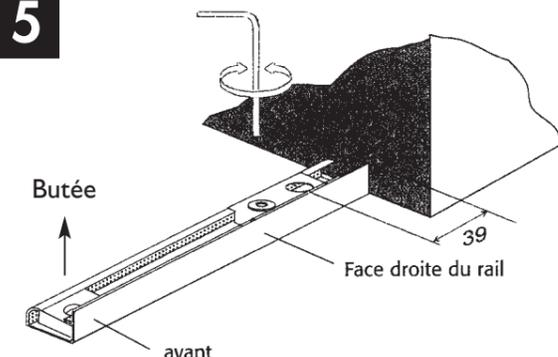
Prérégler l'axe du trou du support à 39 mm du mur.
