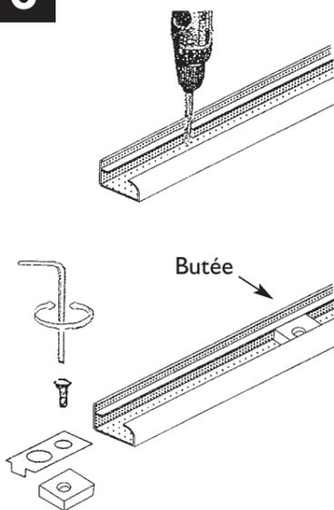
a) Perçage des rails  $\varnothing 4$ . 1<sup>er</sup> trou à 70 mm de chaque extrémité, ensuite à environ tous les 300 mm.
